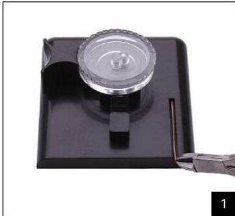
1) Wenn Sie traditionelle Ohrhaken erstellen möchten, platzieren Sie einen 0,8mm starken Draht in der Mess-Nut und längen diesen mit einem Seitenschneider eben am Ende der Nut ab.
