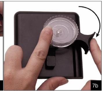
7b) Bis dieser an seiner neuen Position stoppt bzw. an der Drahtauflage anstößt. Während diesen Handgriffen sollten Sie der Drahtauflage erlauben sich zu bewegen, damit der Draht sauber geformt wird.
