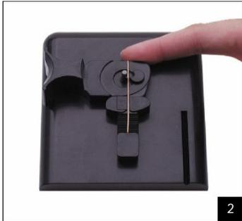
2) Nehmen Sie den transparenten Deckel mit dem Metallstift auf der Unterseite ab und stellen Sie die Biegevorrichtung in die Startposition. Dabei ist zu beachten, dass Hebel und Drahtauflage im rechten Winkel zueinander stehen. Die Drahtauflage steht parallel zu der Mess-Nut (siehe Bild).
