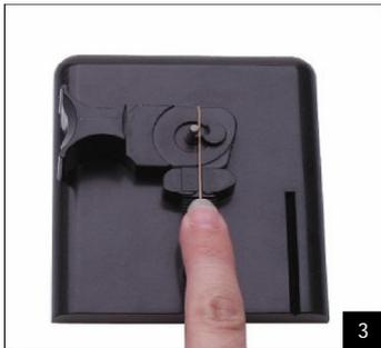
3) Legen Sie den Draht in die Mulde in der Drahtauflage. Schieben Sie den Draht solange zu sich er bis dieser am Stopper (kleiner Absatz) an der Drahtauflage rastet. Halten Sie den Draht mit Ihrem rechten Zeigefinger an der geriffelten Stelle der Drahtauflage fest, damit der Draht nicht wegrutschen kann.
