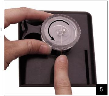
5) Mit Ihrer linken Hand halten Sie den transparenten Deckel leicht nach unten und drehen diesen gegen den Uhrzeigersinn bis die kleine Öse gebogen ist und Sie einen stärkeren Widerstand verspüren.
